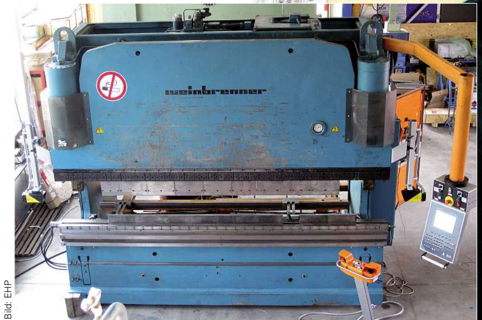
Diese Weinbrenner-Abkantpresse vom Typ GP 200×3550, Baujahr 1987, wurde kürzlich generalüberholt und an den Kunden in Bayern übergeben. Installiert wurden unter anderem eine speicherprogrammierbare Steuerung, eine neue CNC-Steuerung und ein Zweihand-Bedienpult.
