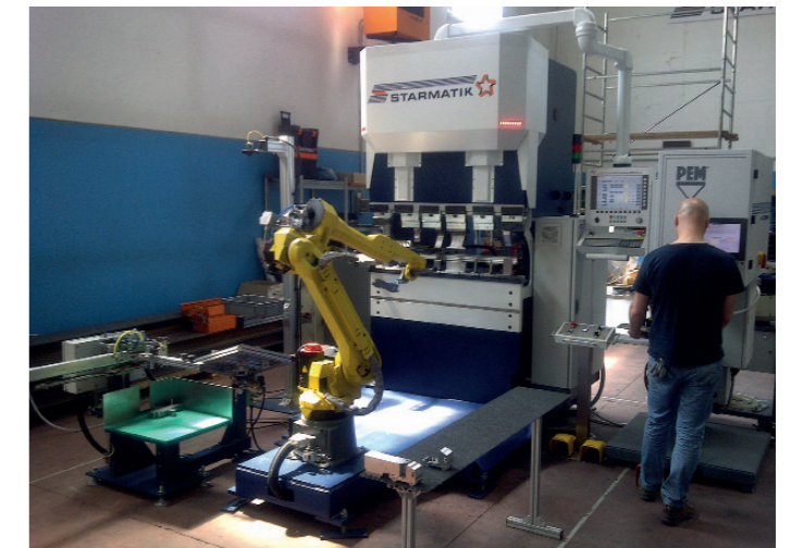
03 Das Blue-Bending-Konzept kann auch in einer automatisierten Form umgesetzt werden. Damit lassen sich mit noch höheren Arbeitsgeschwindigkeiten Teile vollautomatisch biegen und ablegen
